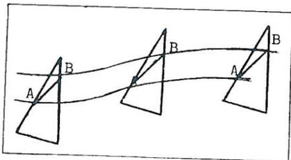
Fig. 1 Traslación de un cuerpo rígido
